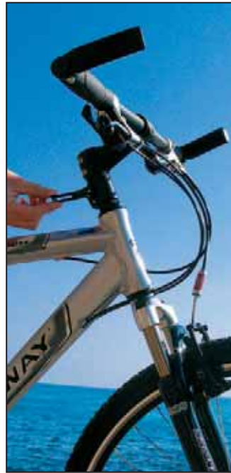
Ist der Speedlifter eingebaut, hat man's leicht: Hebelchen auf ...
